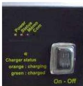
Les différentes LEDs (Power, Status, Mem et Com) permettent de déterminer dans quel état est l'appareil :
