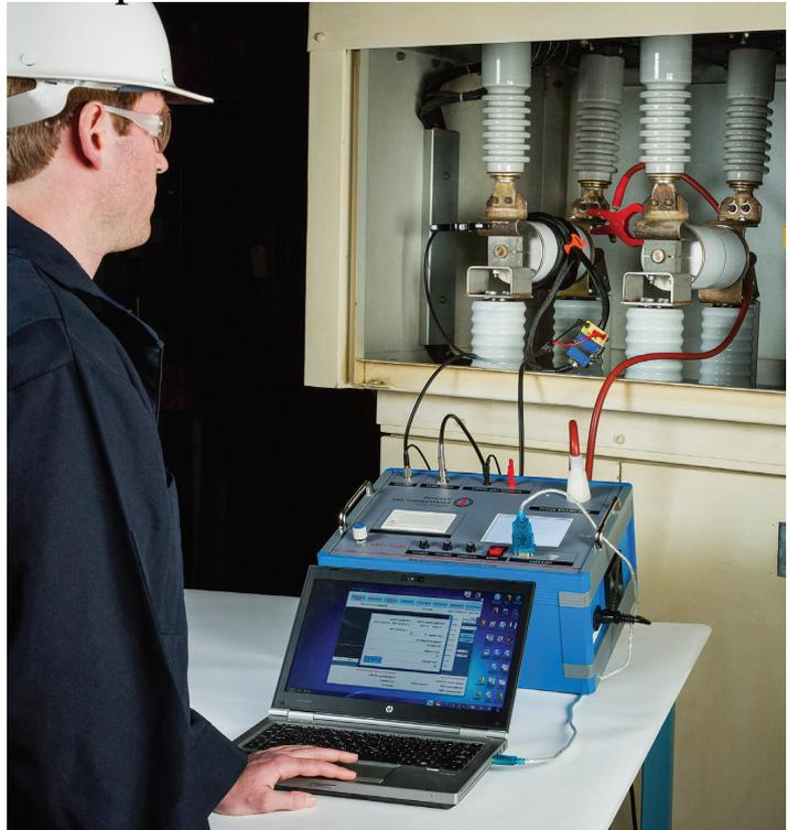
Il est bien connu que les chambres de coupure sous vide fonctionnent bien jusqu'au moment où elles ne fonctionnent plus, parfois avec des résultats catastrophiques. Le **MAC TS4** permet de prévoir la durée de vie restante des chambres, sans nécessité de démontage pour faire les tests en laboratoire.
