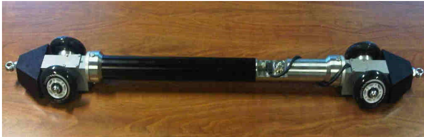
ABM 90 avec les petites roues inclinées - D. I. de 150 à 300
